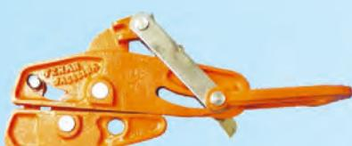
Namenjena za vuču i zatezanje Al i AlČe provodnika spoljašnjeg prečnika 6 do 14 mm. Njena konstrukcija sistemom poluga hvata provodnik a pri povlačenju automatski se pojačava sila stezanja hvataljke na provodnik i time se omogućava brza i čvrsta veza, za vuču i zatezanje. Maksimalna sila zatezana je 400kg. Automatska hvataljka ima ugrađenu U - sponu koja omogućava brzo i lako povezivanje sa vučnim uređajem. Hvataljka je izrađena od specijalne legure Al.
