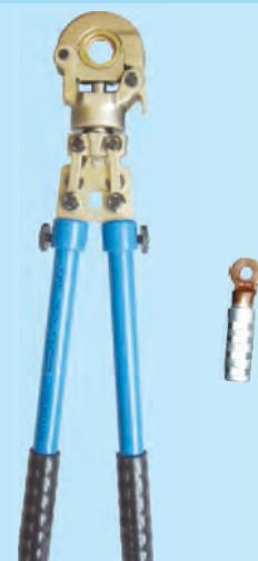
Ova presa je nastala na temelju usavršavanja FEMAN-ovih ručnih mehaničkih presa tako da danas važi za najbolju ručnu mehaničku presu. Glava prese je okretna za 360° što omogućava presovanje u svim položajima. Ručice su teleskopske, izvlače se od 600-800mm i znatno u zavisnosti od dužine poluga smanjuju silu kojom bi trebalo da deluje monter na ručice prilikom presovanja. Ručice se izvlače kada se radi sa većim presama, za presovanje manjih preseka dovoljna je i standardna dužina ručica.
