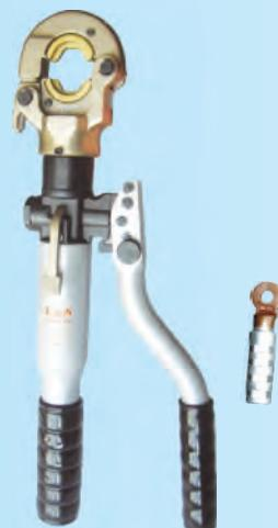
Kompaktna presa sa ugrađenom hidrauličnom pumpom visokog pritiska 700 bar-a. Koristi se za presovanje kablovskog pribora za Cu provodnike 10-300mm, i Al provodnike 10-240 mm, zarezne spojnice, oblikovači sektorkog kabla i FID čaure. Glava prese je okretna za 360° stepeni što omogućava presovanje u svim položajima. Presa i umetci se poručuju posebno i smešteni su u odgovarajući kofer.
