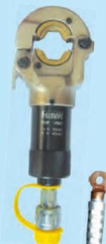
Koristi se za presovanje Cu provodnika preseka 10-300mm<sup>2</sup> i Al provodnika 16-240mm<sup>2</sup>. Glava je okretna za 360° što omogućuje rad u svim položajima. Za pogon ove hidraulične glave koristi se FEMAN hidraulična pumpa koja se poručuje posebno.
