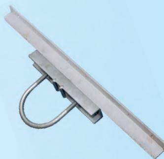
Konzola se montira na stablo bandere pritezanjem navrtki na čeličnoj obujmici čiji je presek uslovjen presekom stabla stuba. Konzola opšte namene izrađuje se od UNP 65 profila, distance i nosač izrađuju se od TV lima u kvalitetu. Antikorozivna zaštita postupkom galvanskog cinkovanja, a po želji kupca radimo i toplo cinkovanu.
