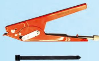
Koristi se za zatezanje vezica širine do 13 mm prilikom obmotavanja i fiksiranja kablovskih snopova. Na kleštima postoji i mogućnost regulacije sile stezanja vilice, čime se omogućuje odsecanje viška vezice nakon ostvarivanja zadate sile.
