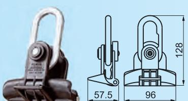
Koristi se sa konzolama za NN SKS za noseće prihvatanje NN SKS-a na stubovima. Prihvatanje se vrši preko nosećeg provodnika (54-71,5 mm). Izrađena je od materijala visoke mehaničke čvrstoće i otpornog na atmosferske uticaje. Savremena konstrukcija omogućava brzu, laku i pouzdanu montažu. Posle postavljanja nosećeg provodnika stezaljka se zatvara specijalnom kopčom koja onemogućava slučajno otvaranje stezaljke i opuštanje SKS-a. Stezaljka je urađena u skladu sa standardom EN 50483.
