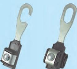
Stezaljka je namenjena za zatezno, noseće prihvatanje dva ili četiri izolovana provodnika. Koristi se za montažu distributivnog voda manjih preseka, kao i za zatezanje provonika za kućne priključke. Izrađena je od visoko kvalitetnih materijala, velike mehaničke čvrstoće, otpornog na sve atmosferske uticaje. Urađena je u skladu sa standardom EN 50483.
