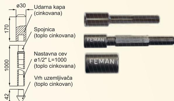
Dubinski štapni nastavni uzemljivač - DIN 48852 ima funkciju da obezbedi odvođenje direktnog atmosferskog pražnjenja, kao i druge vidove električnih pražnjenja, u zemlju bez stvaranja opasnih strmih prenapona na području uzemljivača. Izrađuje se od materijala koji mogu podneti bez oštećenja sva dinamička svojstva struja direktnih atmosferskih pražnjenja kao i druga mehanička naprezanja. Uzemljivač je elektrolitički obrađen tako da je pojava korozije u toku eksplatacije isključena.
