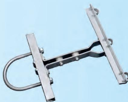
Konzola se montira na stablo bandere pritezanjem navrtki na čeličnoj obujmici čiji je presek uslovjen presekom stabla stuba. Konzola opšte namene izrađuje se od UNP 65 profila, distance i nosač izrađuju se od TV lima u kvalitetu. Antikorozivna zaštita postupkom galvanskog cinkovanja, a po želji kupca radimo i toplo cinkovanu.
