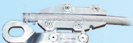
Služi za zatezanje Al-Fe užadi prečnika 8-24 mm. Izrađena je od legiranog čelika, a paknovi su od Al legure. Ako se koristi za zatezanje čeličnih užadi i sajli (što treba naglasiti prilikom porudžbine) paknovi se rade od čelika. Maksimalna zatezna sila je 2000 kg.
